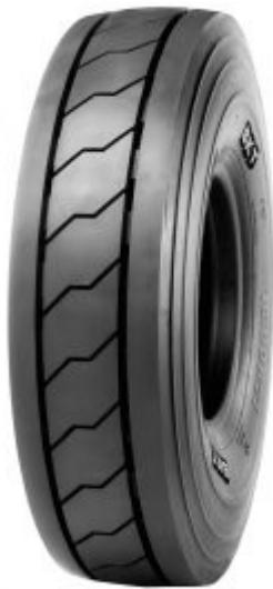
Esposti sullo stand anche i pneumatici **PORTMAX PM 93** e **BK-LOADER 53**. Il primo è specifico per il trasporto intermodale, ed è perfetto per equipaggiare gli straddle carrier, le cosiddette gru a cavaliere. Particolarmente resistente, di lunga durata e con alta capacità di carico, **PORTMAX PM 93** movimenta i carichi più pesanti e mantiene un'elevata stabilità. Non da ultimo, assicura all'operatore una guida più confortevole, senza slittamenti, riducendo il consumo di carburante.
