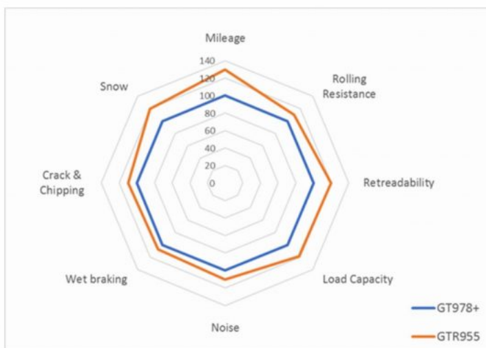
Grafico: Comparazione delle performance del Giti GTR955 Combi Road e di quelle del prodotto precedente, il Giti GT987+
