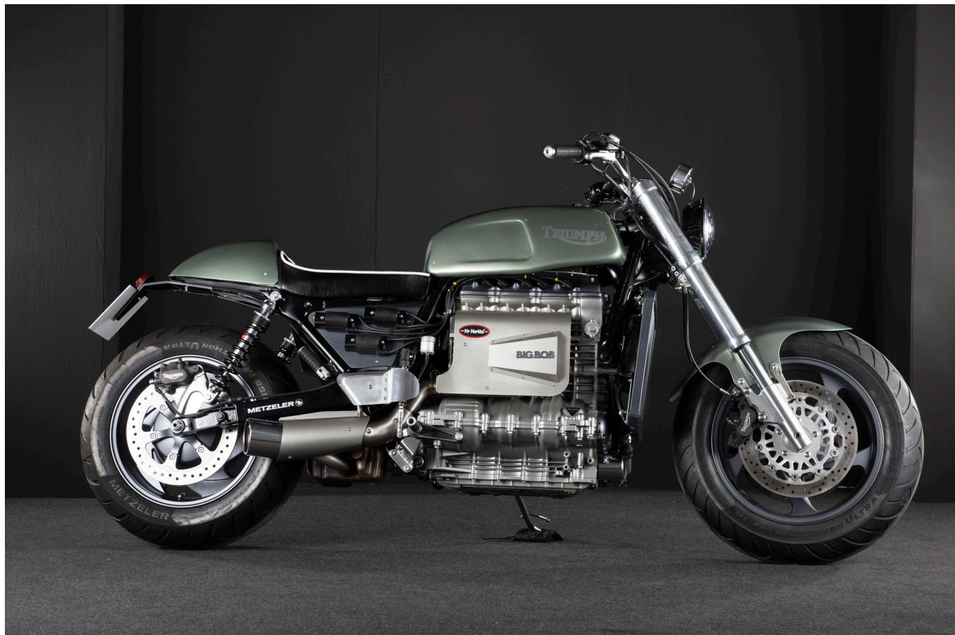
La carrozzeria è interamente realizzata in carbonio CFRP (Carbon Fiber Reinforced Polymer) lavorato in autoclave. La parte posteriore si solleva e dà accesso ai due vani laterali che sostituiscono le borse originali, mentre il serbatoio è un pezzo unico in monoscocca. Il processo di lavorazione della carrozzeria, unitamente ad altri dettagli esclusivi, come la sospensione posteriore pneumatica ad aria, rendono esclusivo anche il prezzo della Flagship, che è già stata venduta a 174.000 euro.
