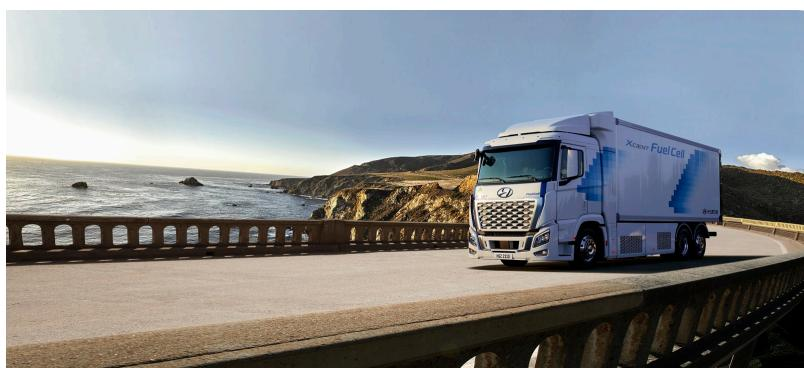
XCIENT Fuel Cell è dotato di un sistema di celle a combustibile a idrogeno da 180 kW con due pile di celle a combustibile da 90 kW ciascuna. La durabilità e l'efficienza complessiva del sistema di celle a combustibile sono state migliorate per essere al passo con le richieste dei clienti delle flotte commerciali. Il motore elettrico da 350 kW con una coppia massima di 2.237 Nm consente inoltre prestazioni di guida dinamiche. I sette grandi serbatoi offrono
