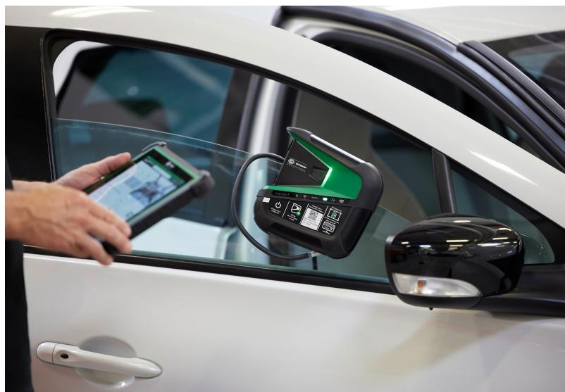
In questo modo la valutazione si basa su una serie di dati che permette un'analisi oggettiva dello stato della batteria ad alta tensione e permette di trarre conclusioni sul comportamento precedente di utilizzo. Ciò risulta importante poiché il verificarsi di cariche rapide o scariche profonde aumenta in modo significativo il processo di invecchiamento di una batteria agli ioni di Litio.
