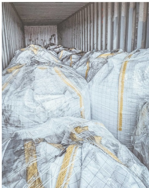
I BigBag con rCB provenienti dal processo di riciclo vengono raccolti da Pyrum e utilizzati per la produzione di nuovi pneumatici Schwalbe.
