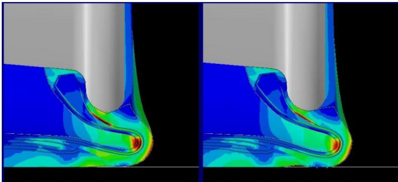
*Confronto tra generazione di calore e deformazione sotto carico (a sinistra: pneumatico standard; a destra: pneumatico HLC) I pneumatici HLC generano meno calore e hanno una maggiore tenuta del carico. Le simulazioni vengono eseguite con carichi maggiori del previsto nell'uso reale.*
