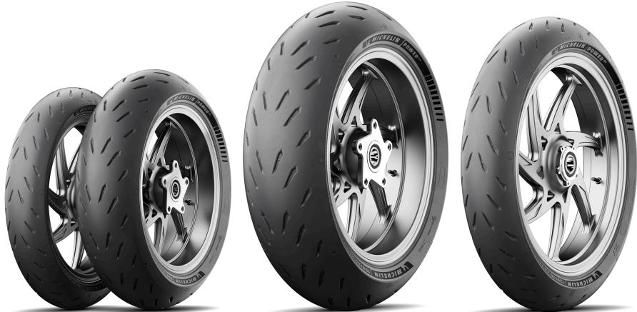
Questo pneumatico è **bi-mescola:** le **Two Compound Technology (2CT)** e **Two Compound Technology + (2CT+)** consentono un'ottima aderenza in curva grazie alle mescole al nero di carbone, **un tasso di intaglio del battistrada del 6,5%** e **ampie zone slick sulle spalle.**
