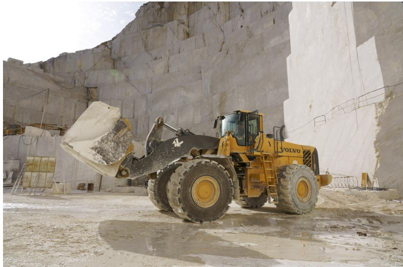
Nuovi prodotti sono stati recentemente introdotti: l'ultimo TL559S+ L5 \*\*\* L5 nelle misure 20.5R25 e 23.5R25, specificamente progettato per pale gommate, sia per miniere di superficie che sotterranee, consente di trasportare carichi maggiori rispetto al precedente indice di carico a 2 stelle versione e offre maggiore resistenza agli urti, maggiore usura e massima capacità di carico.
