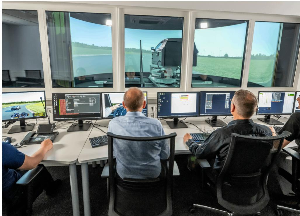
Ogni ciclo di prova completato nel simulatore di guida invece che su strade reali significa meno pneumatici di prova da produrre. L'investimento in questa nuova tecnologia di test si aggiunge quindi alle ampie attività di sostenibilità di Continental.
